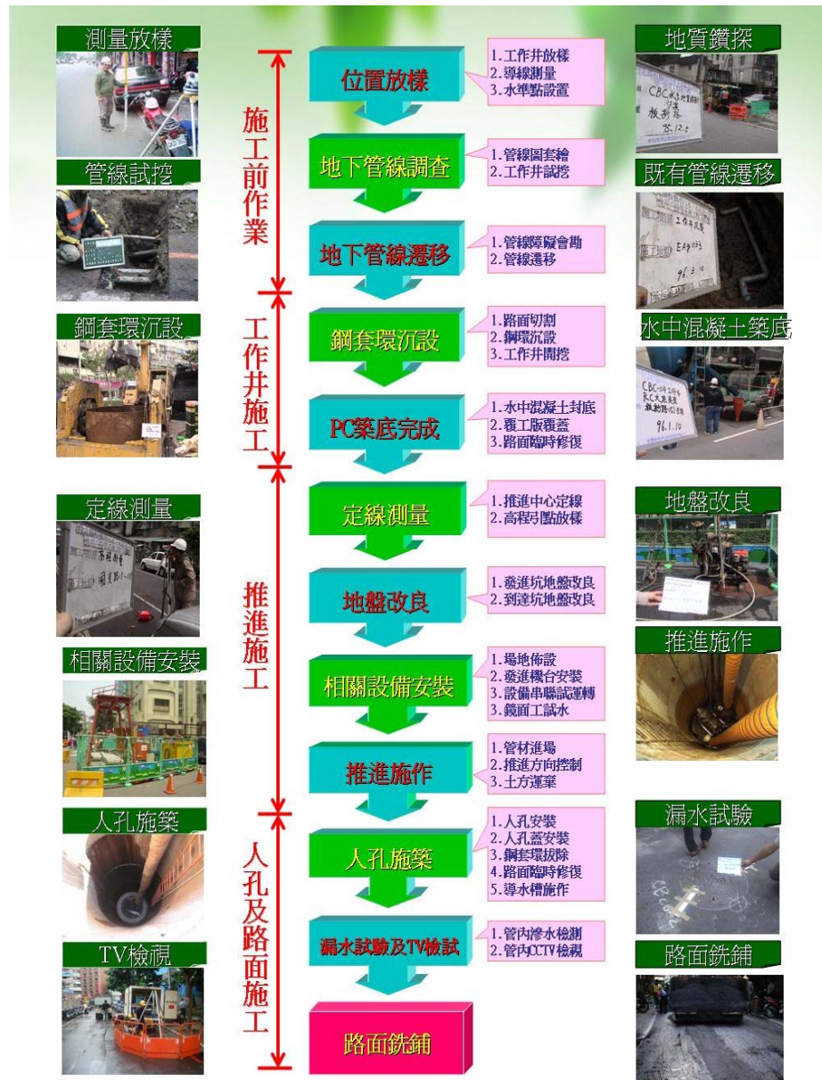
圖 4.3-1 管網施工流程示意圖
