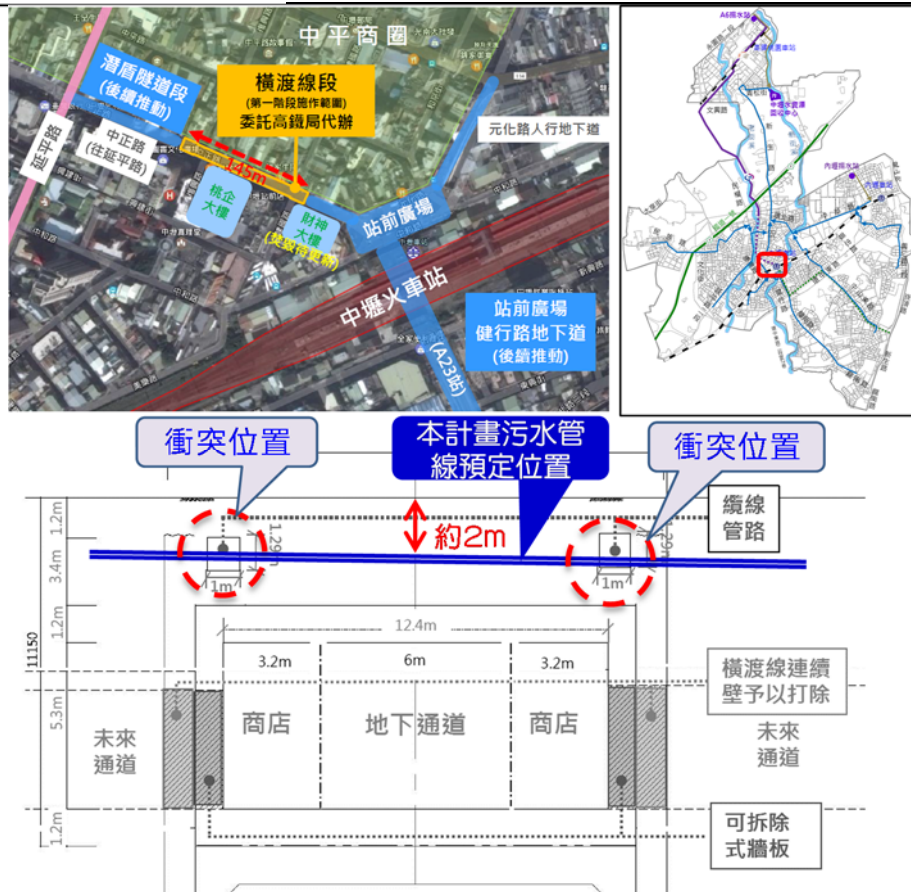
圖 4.2-27 捷運機場線橫渡段斷面示意圖
