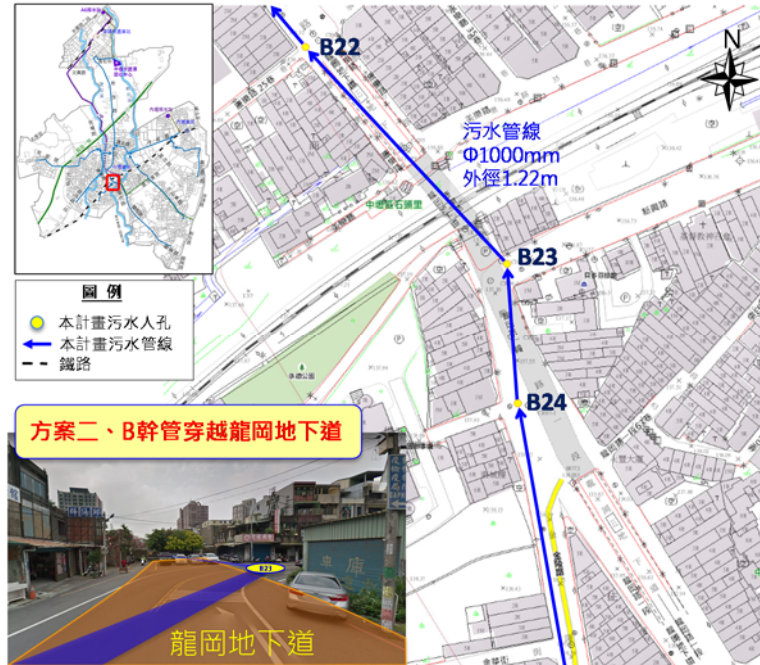
圖 4.2-14 B 幹管穿越鐵路(67K+680)方案二平面圖
