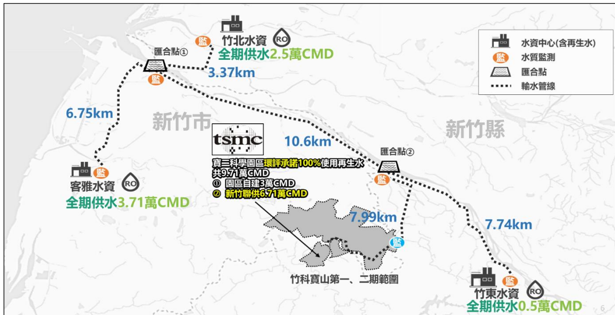
圖 3-12 新竹聯合供應案之輸送管線配置示意圖
