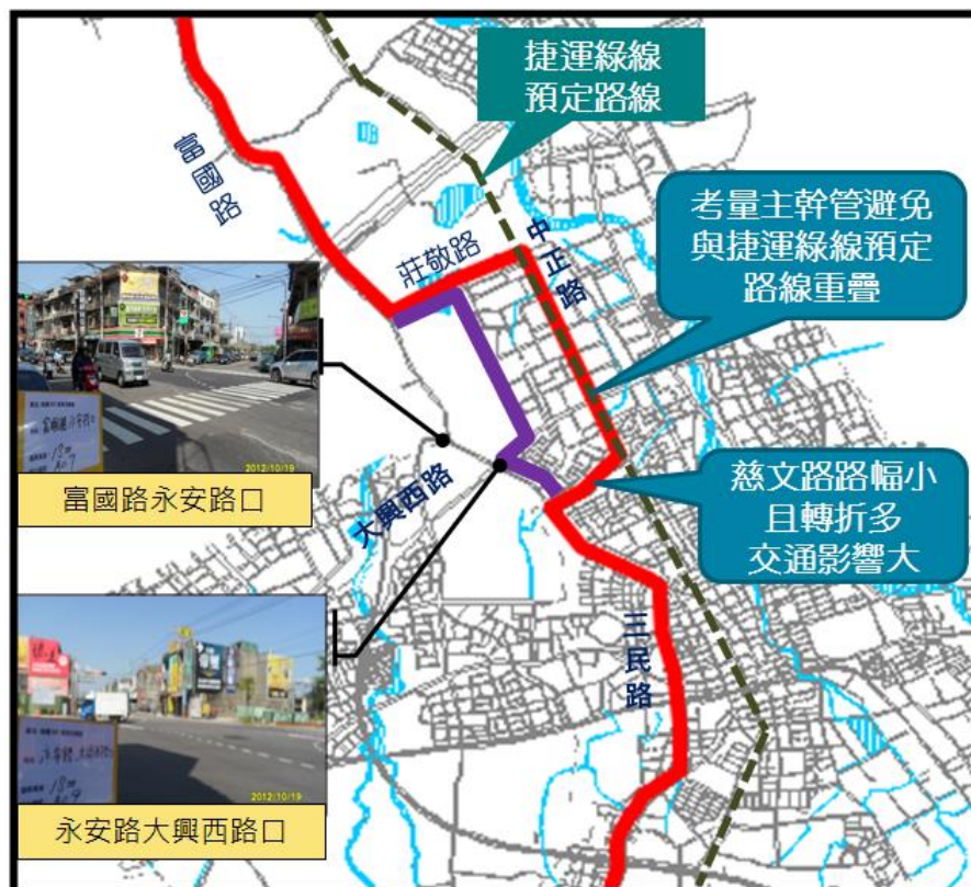
圖 4.2-2 主幹管路污水管線配置圖
