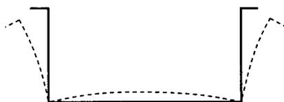
圖 C-6.2-6 U 型斷面梁之側向挫屈
