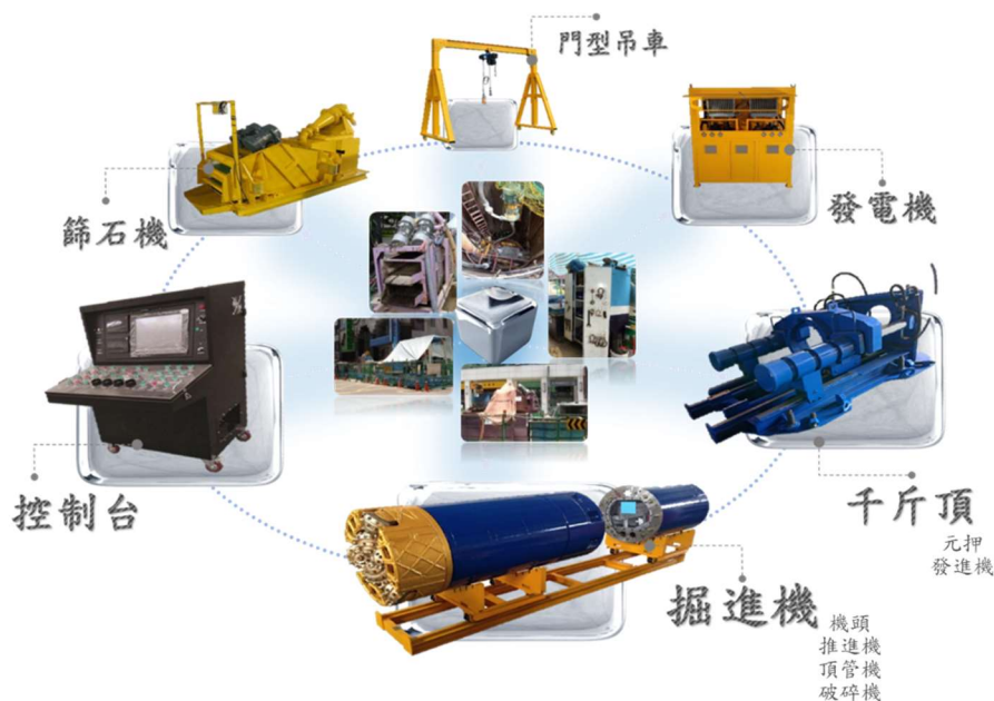
圖 3.4-1 下水道推進工程常見設備圖
