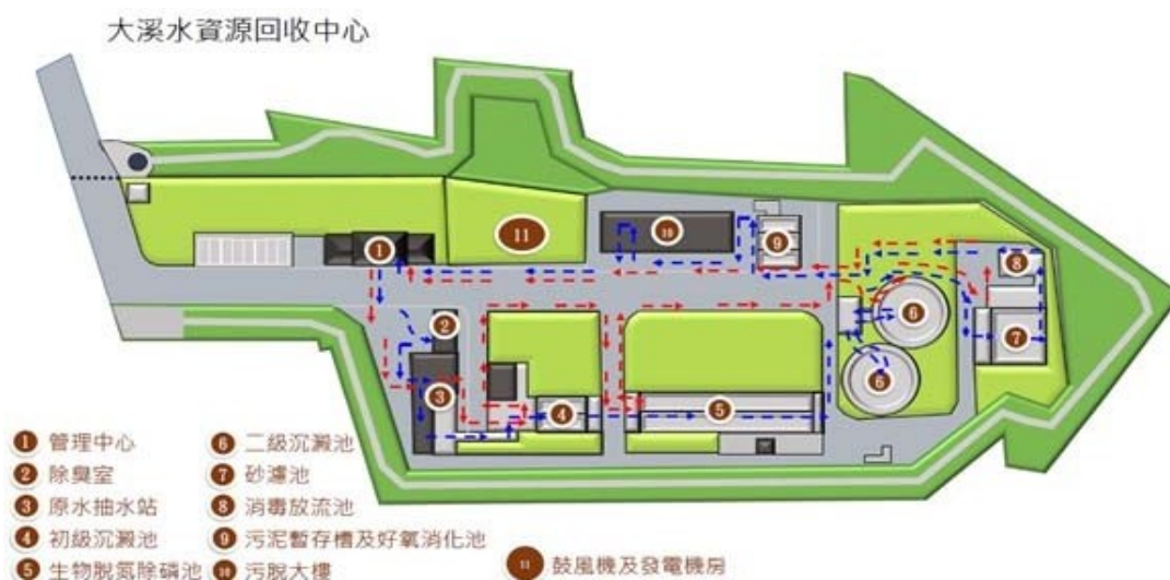
圖 3 大溪水資源回收中心平面配置圖
