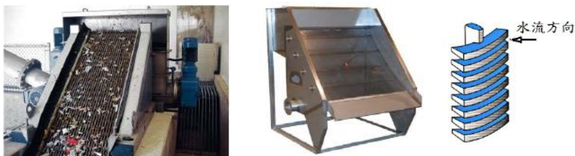
a.操作情況照片 b.外觀照片 c.楔型柵條
