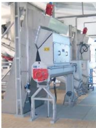
b.階梯式細攔污柵裝設照片 c.裝設在渠道內之階梯式柵板
