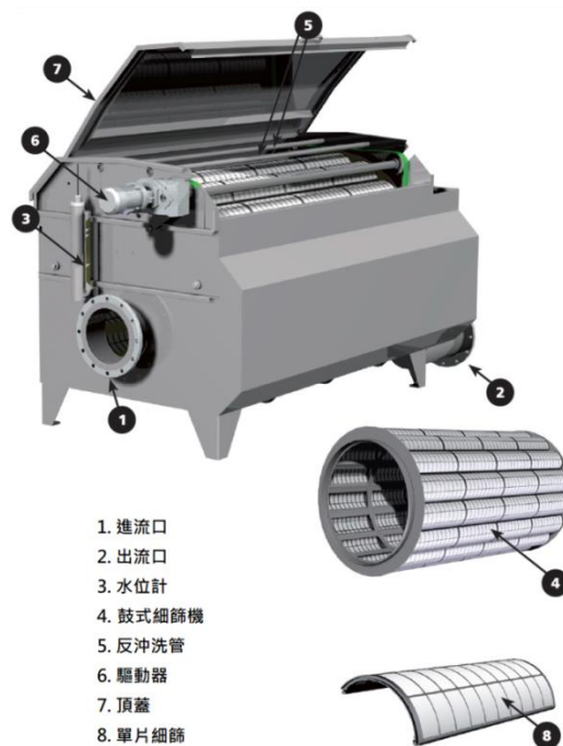
圖 3.18 旋轉鼓式細篩機
