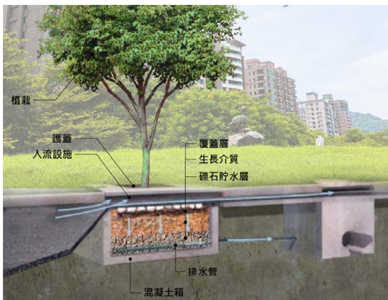
樹箱過濾設施組成結構剖面示意圖
