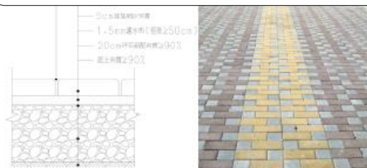
透水鋪面斷面及示意圖
