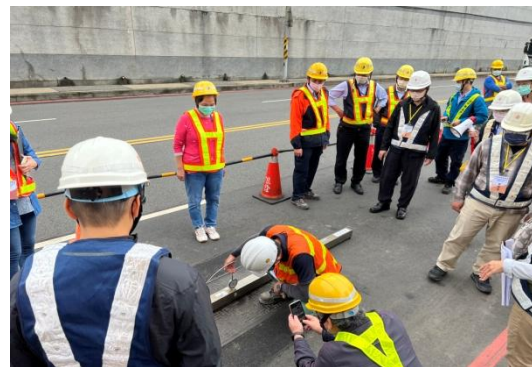
基隆市 中華電信案件 國營事業道路復舊考評現場實地量測路平整度
