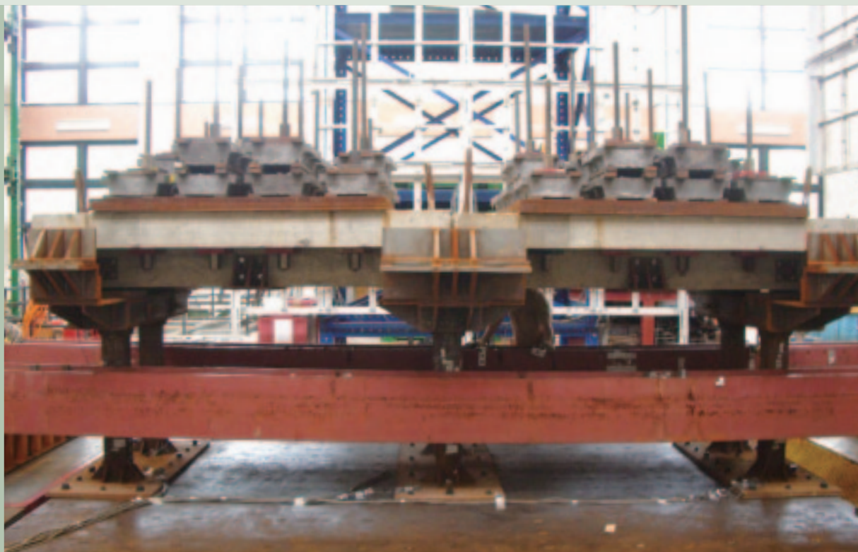
◆ 縮尺橋梁震動臺試驗
